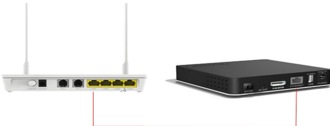
Slika 1. Povezivanje STB-a sa optičkim modemom
